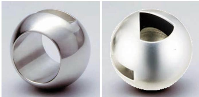
Для уменьшения износа седла и увеличения срока эксплуатации крана рабочая кромка шара делается закругленной.
