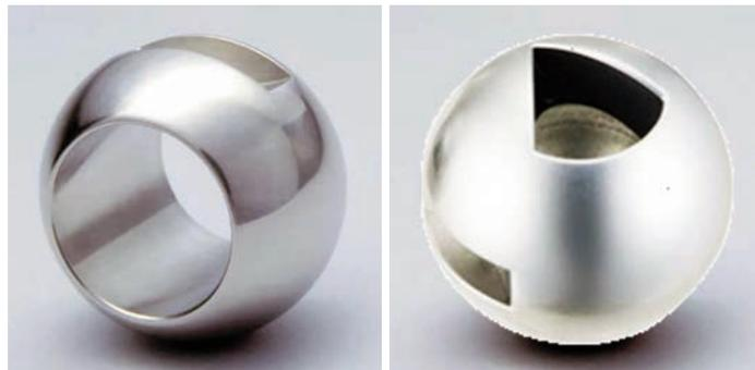
В регулируемых кранах шар имеет V-образный вырез, что позволяет регулировать поток рабочей среды на выходной стороне крана.
