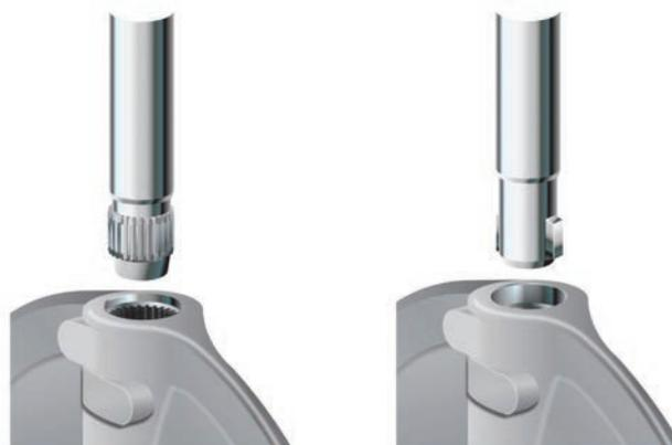
Для затворов DN 1400...2400 сочленение штока с диском выполняется при помощи шпоночного соединения.
